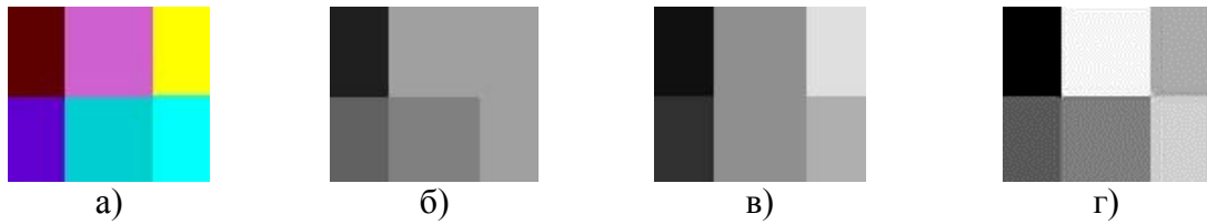
Рис.1. Преобразование цветного изображения в полутоновое: а) исходное; б) формулой (1); в) формулой (2) и г) с помощью проекции на главную компоненту
