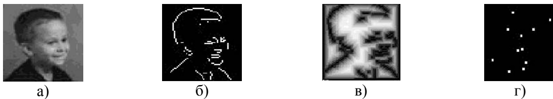
Рис.3. определение стартовых точек: а) полутоновое изображение; б) края; в) карта расстояний и г) стартовые точки
